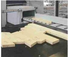
Weitere Nutzen für Sie sind das mehrlagige Sägen um hohe Kapazitäten zu erhalten. Bearbeiten von Stieglägern z.B. T-J-Trägern oder anderem Material sowie das definierte Ausfordern von Keinteile bis 160 mm so daß automatisierte Produktionsabläufe manlos möglich sind.
