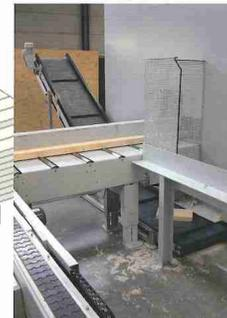
Förderband für die automatische Reststückentsorgung (Option)
